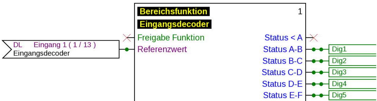
Der DL-Eingang mit dem **Index 13** gibt eine Zahl zwischen 0 und 31 aus, die vom Binärdecoder in eine binäre Zahl mit den Eingangszuständen decodiert wird. Daher muss jener DL-Eingang (wie in der Grafik) mit der Eingangsvariable **Referenzwert** verbunden werden.
