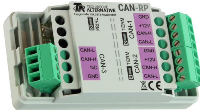
El repetidor CAN **CAN-RP** permite que pueda haber cables de derivación en la red de bus CAN. En la red de bus CAN, la conexión **CAN-3** está aislada eléctricamente de las conexiones **CAN-1** y **CAN-2**.
