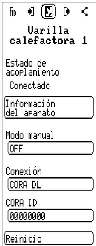
El **estado de acoplamiento** indica si hay una conexión de radio con el aparato.
