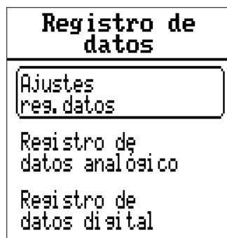
En este menú se definen los ajustes para el registro de datos mediante bus CAN o en la tarjeta SD del regulador para valores analógicos y digitales.
