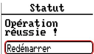
À la fin du menu « Gestion Données », il est possible d'effectuer un redémarrage du compteur d'énergie après avoir répondu à une question de sécurité sans isoler le compteur d'énergie du réseau électrique.
