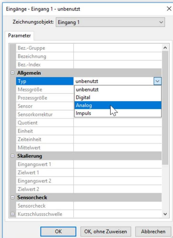
Es stehen 3 Typen des Eingangssignals zur Verfügung:
