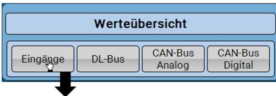
In der Werteübersicht werden alle Eingangs-CAN-Bus und DL-Werte angezeigt.
