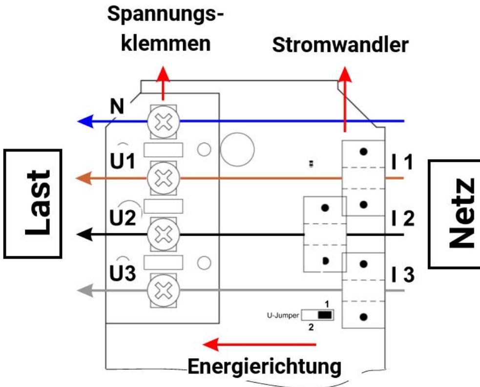
Wird die Energierichtung geändert, so zählt der Energiezähler negativ.
