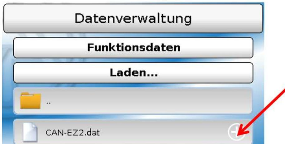
Um die Datei an das Modul zu senden, tippt man auf das Dateisymbol, dann wird eine Auswahl sichtbar.
