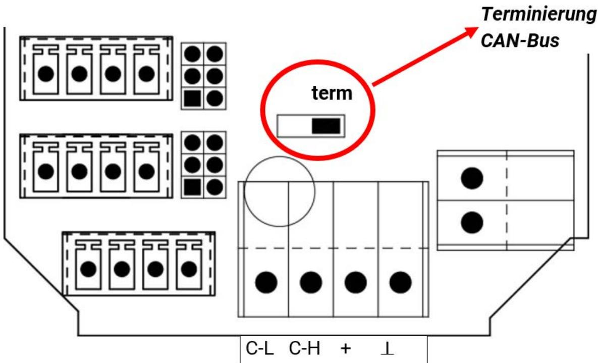
Der CAN-EZ ist terminiert, wenn der Jumper auf der Seite der Beschriftung „**term**“ gesetzt ist (wie oben abgebildet).
