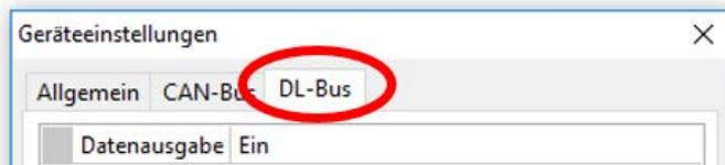
Im Menü Datei / Einstellungen / Geräteeinstellungen / DL-Bus kann die **Datenausgabe** für das **Datenlogging** über DL-Bus und für die Anzeigen im Raumsensor **RAS-PLUS** ein- oder ausgeschaltet werden.
