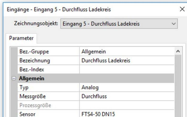
Der Volumenstrom des **Sensors an VT1** wird am **Eingang 5** gemessen (**Beispiel**: Sensor FTS4-50).
