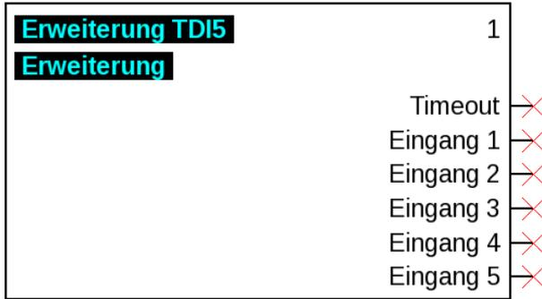
Es wird das CORA-Gerät „Erweiterung TDI5“ verwendet (TAPPS2 Mindestversion: **1.20**). Die CORA-ID ist einzugeben (zu finden auf einem Aufkleber am Gehäuse).
