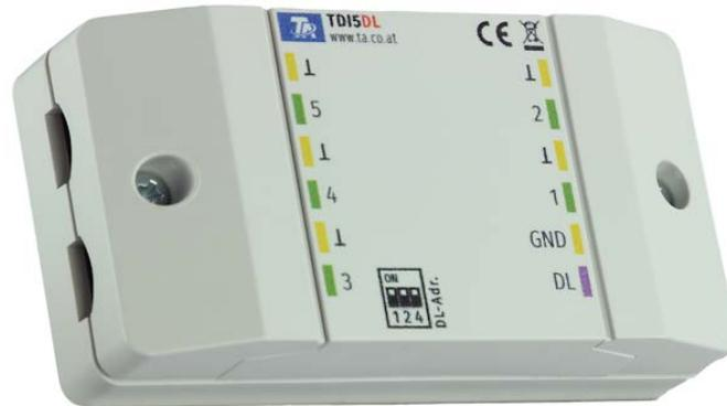
Der **TDI5-DL** (Temperature and Digital Input) übersetzt bis zu fünf Signale für die Datenleitung (DL-Bus) oder CORA-DL, diese können entweder ein Digitalsignal (Ein/Aus) oder der Messwert eines PT1000-Sensors sein. **Digitalsignale müssen potentialfrei sein. Achtung:** Wegen der Trägheit des DL-Busses ist dieses Modul **nicht** für zeitkritische Verwendungen geeignet (z.B. Digitaleingänge als Taster).
