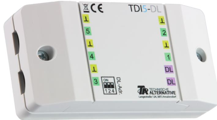
TDI5-DL (Temperature and Digital Input) traduce hasta cinco señales para la línea de datos (Bus DL), que pueden ser una señal digital (On/Off) o un valor de medición de un sensor PT1000. **Las señales digitales deben ser de cero voltaje.**
