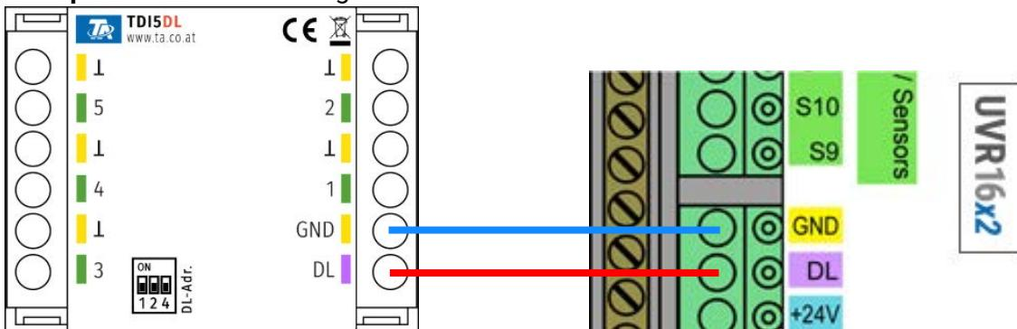
Les bases du câblage du bus DL sont décrites en détail dans les notices d'instructions des régulateurs à programmation libre. La polarité du câble de données est permutable.
