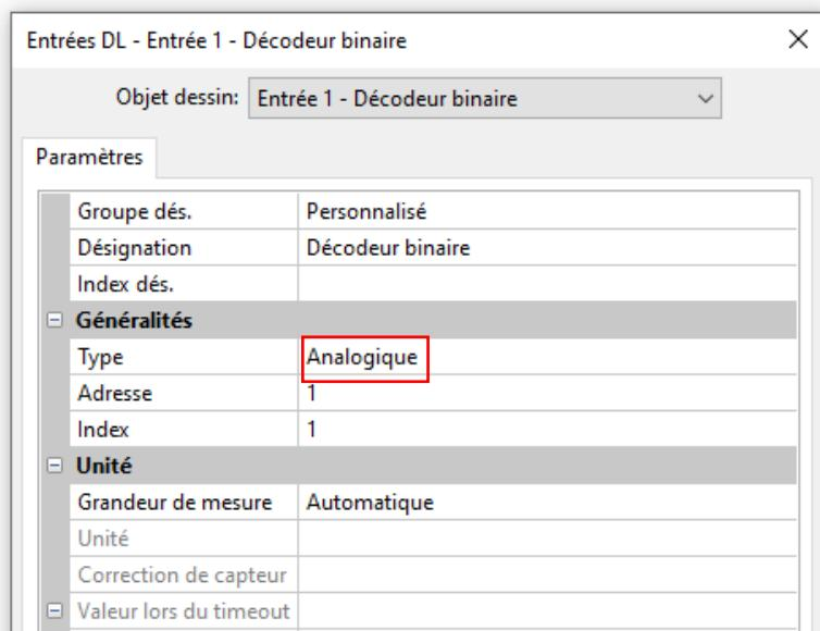
Les réglages les plus importants se trouvent à la rubrique **Généralités**. Si une entrée numérique (Marche/Arrêt) doit être relevée (index 1-5), le type doit être défini sur **Numérique**; sinon, le définir sur **Analogique**. En outre, l'adresse de bus DL paramétrée sur TDI5-DL (usine 1) doit y être indiquée, ainsi que l'index de l'entrée souhaitée.
