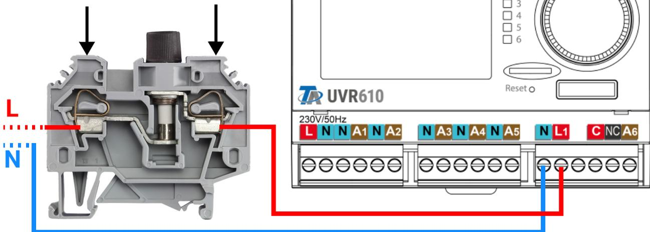
La clip di fissaggio viene collegata a **L1**. È necessario osservare la direzione secondo il grafico di collegamento (vedere la dicitura "INPUT" sul lato superiore).
