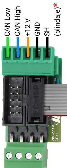
\*El 5º polo (a la derecha del terminal) es para el blindaje del cable bus CAN.
