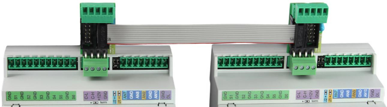
El cable de cinta plana no se ajusta completamente a las especificaciones del protocolo del bus CAN, pero esto es irrelevante en longitudes cortas (123 mm).
