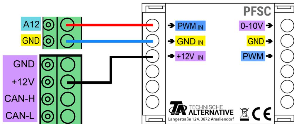
**MLI et GND** sur la sortie analogique du régulateur sont raccordés au côté gauche. L'alimentation **12 V** (du bus CAN) est également nécessaire.
