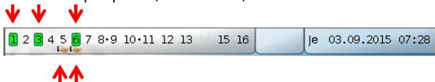
La sortie 5 a été **désactivée** manuellement (Manuel/Arrêt), et la sortie 6 **activée** manuellement (Manuel/Marche). Les sorties qui ont été commutées sur Manuel/Arrêt ou Manuel/Marche sont caractérisées par le **symbole de la main** affiché au-dessous du numéro de la sortie.
