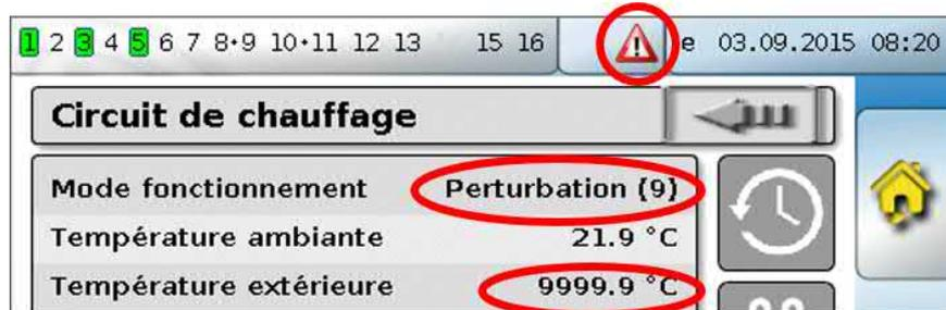
Réglages pour le **fonctionnement du circuit de chauffage** avec lien vers le paramètre de la courbe de chauffage :
