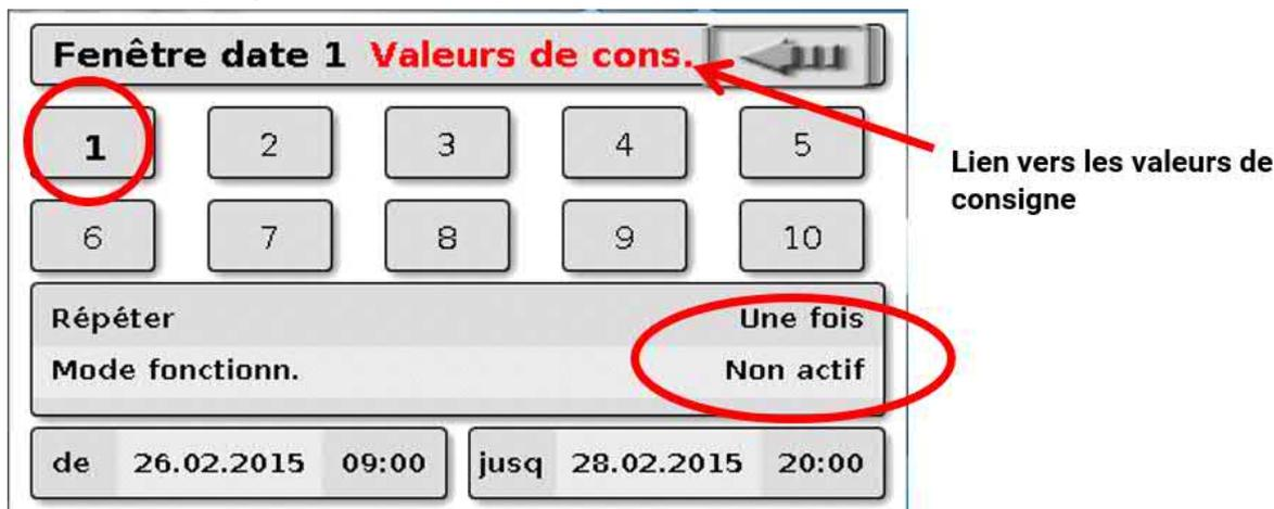
Actuellement, la fonction de calendrier est **inactive**. C'est ici qu'est défini si le mode de calendrier doit s'appliquer une seule fois ou tous les ans. Le mode de fonctionnement souhaité est défini en effleurant le champ **Mode de fonctionnement** affiché :
