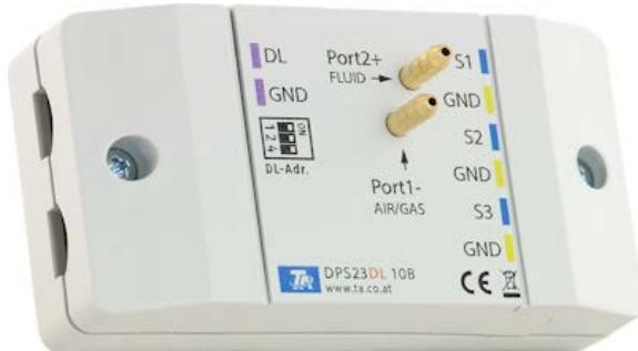
Der Differenzdrucksensor **DPS23-DL** misst die Druckdifferenz zwischen den zwei Ports. Alternativ kann einer dieser Ports auch ohne Anschluss verbleiben, wobei der Differenzdruck zwischen Port und der Umgebung des Moduls gemessen wird.
