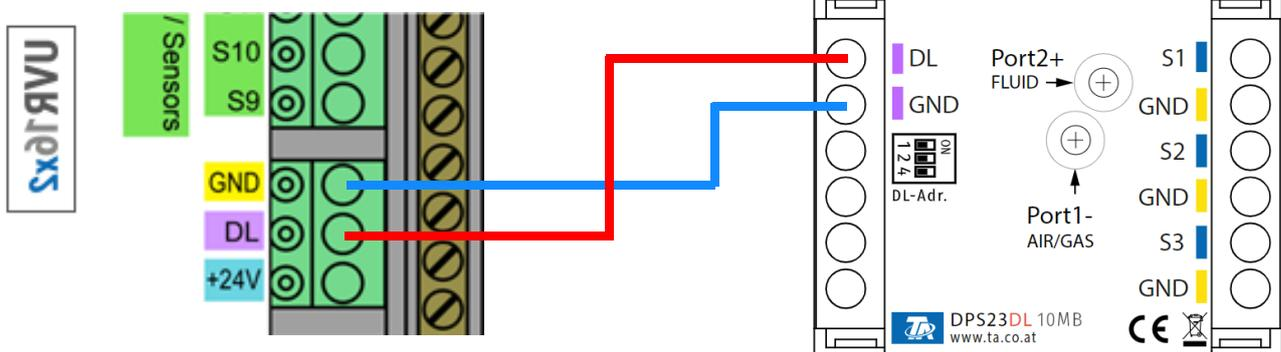
Le basi del cablaggio del bus DL sono descritte in dettaglio nelle istruzioni di montaggio dei tre regolatori programmabili. L'assegnazione dei poli della linea dati è intercambiabile.
