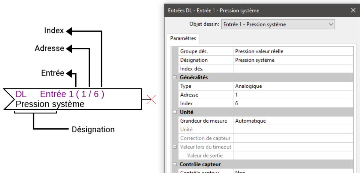
Les réglages les plus importants se trouvent à la rubrique **Généralités**. L'adresse de bus DL paramétrée sur DPS23-DL (usine 1) doit être indiquée, ainsi que l'index de l'entrée souhaitée.
