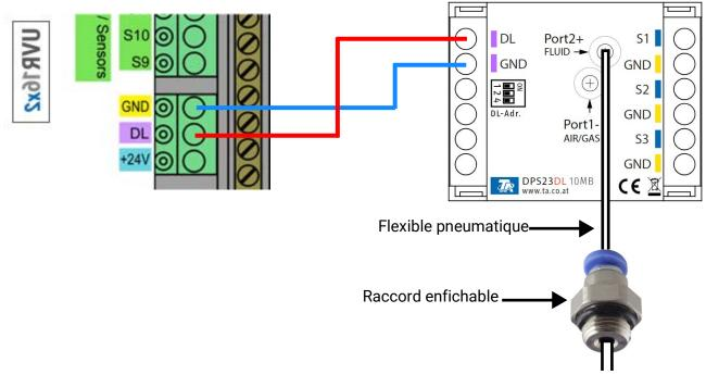
Les bases du câblage du bus DL sont décrites en détail dans les notices d'instructions des régulateurs à programmation libre. La polarité du câble de données est permutable.
