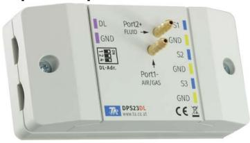
Le capteur de pression différentielle **DPS23-DL** mesure la différence de pression entre les deux ports. L'un de ces ports peut aussi rester sans raccordement. Dans ce cas, la pression différentielle est mesurée entre le port et l'environnement du module.
