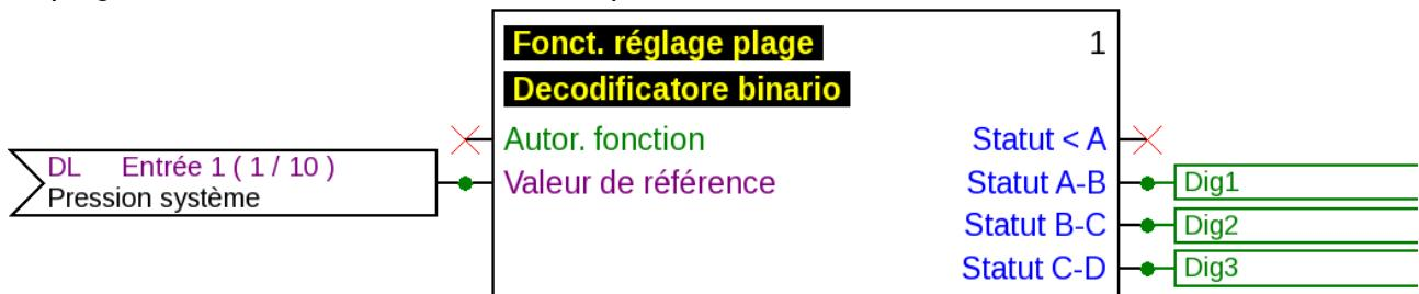
L'entrée DL avec l'**index 13** envoie un chiffre entre 0 et 7 qui est décodé par le décodeur binaire en un chiffre binaire avec les états d'entrée. C'est pourquoi chaque entrée DL (comme dans le graphique) doit être associée à la variable d'entrée **Valeur de référence**.
