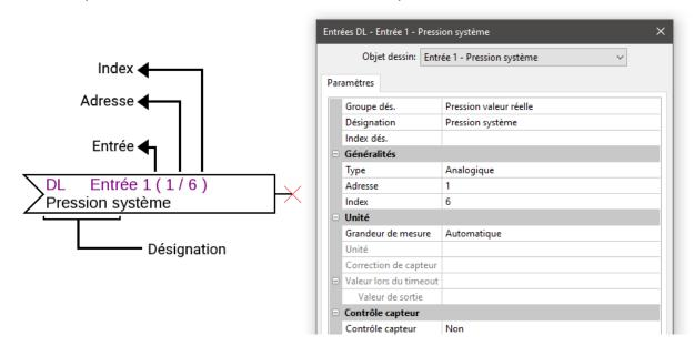
Les réglages les plus importants se trouvent à la rubrique **Généralités**. L'adresse de bus DL paramétrée sur DPS23-DL (usine 1) doit être indiquée, ainsi que l'index de l'entrée souhaitée.
