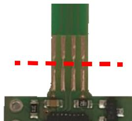
2. Se suelda un cable de cinta plana de 4 polos (distancia entre los polos de 1,27 mm) en ambos extremos.
