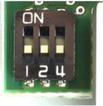
La **dirección** se ajusta con los conmutadores DIP. En estado de suministro, la dirección está ajustada a 1 (ajuste de fábrica).
