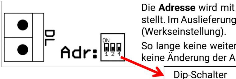
Die **Adresse** wird mit den Dip-Schaltern auf der Platine eingestellt. Im Auslieferungszustand ist die Adresse auf 1 eingestellt (Werkseinstellung).
