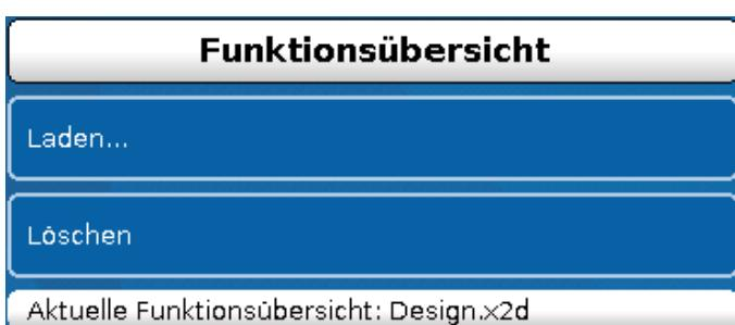
Von der SD-Karte kann die Funktionsübersicht (Datei **\*.x2d**, **TA-Designer Mindestversion: 1.15**) in das Gerät geladen oder im Gerät gelöscht werden. Es können mehrere Dateien auf der SD-Karte gespeichert sein.
