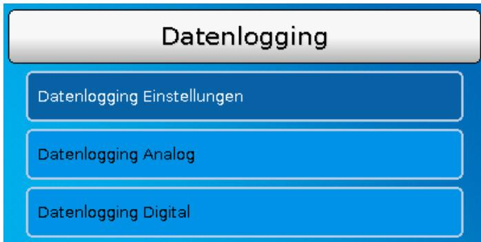
In diesem Menü werden die Einstellungen für das Datenlogging über CAN-Bus oder auf der SD-Karte des Reglers für analoge und digitale Werte definiert.
