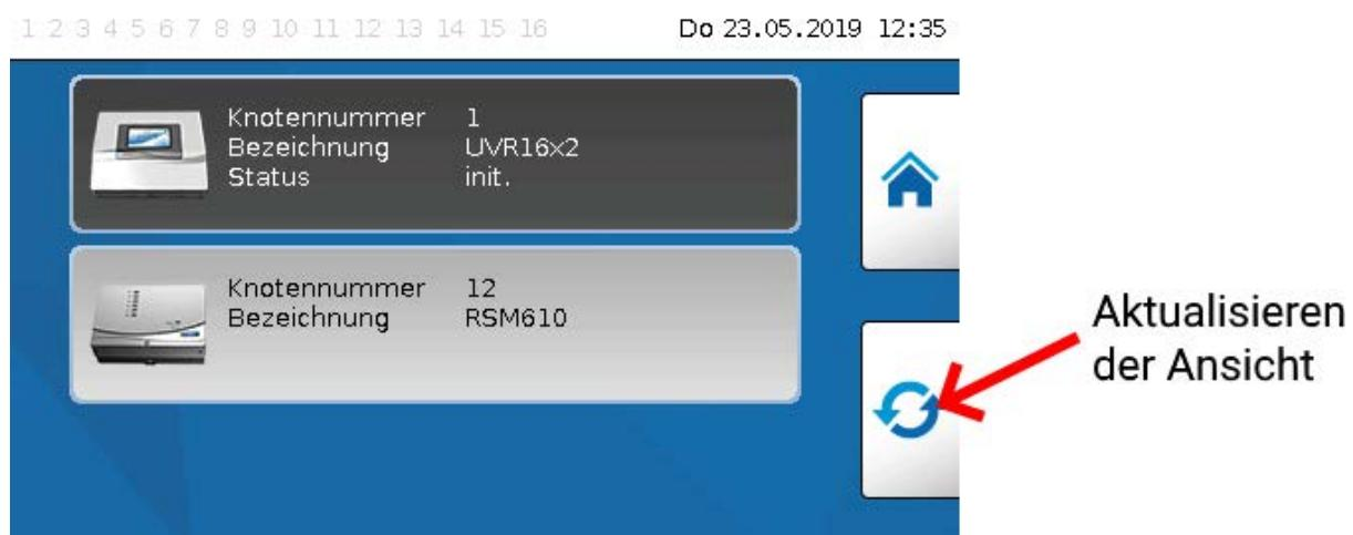
Durch Antippen des Feldes werden die aktiven CAN-Knoten im CAN-Busnetz angezeigt. Mit „Status“ wird der CAN-Bus-Status des Reglers angezeigt. Der Status wechselt nach dem Reglerstart nach einem vorgeschriebenen Verfahren automatisch von **init.** → **preop(erational)** → **operat(ional)**. Erst dann kann mit anderen CAN-Busgeräten kommuniziert werden.
