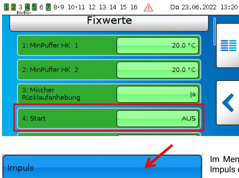
Im Menü des Fixwertes kann ebenfalls ein Impuls durch Antippen ausgelöst werden.
