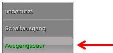
Diese Ausgänge können als einfache Schaltausgänge oder zusammen mit dem **nachfolgenden** Schaltausgang als **Ausgangspaar** (z.B. Ansteuerung eines Mischerantriebs) verwendet werden.
