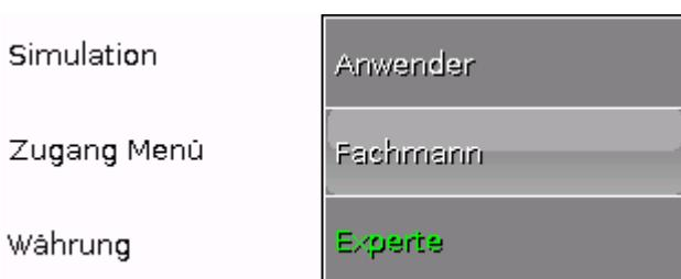
Ist der Zugang zum Menü nur dem **Fachmann** oder dem **Experten** erlaubt, muss bei Anwahl des Hauptmenüs aus der Startseite der Funktionsübersicht (Schaltfläche ) das entsprechende **Passwort** eingegeben werden.
