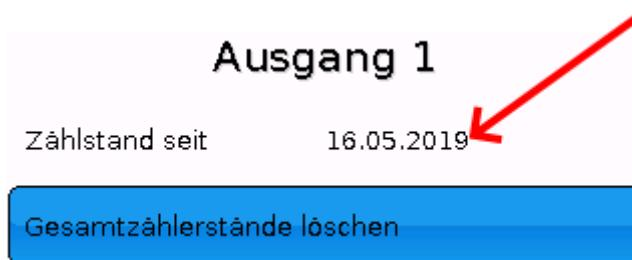
Nach Tippen auf das Schaltfeld wird abgefragt, ob man die **gesamten** Zählerstände und „**Vortag**“ des Betriebsstunden- **und** des Impulszählers löschen möchte. Die Zählerstände „**heute**“ und „**letzter Lauf**“ und „**aktueller Lauf**“ werden damit nicht gelöscht.
