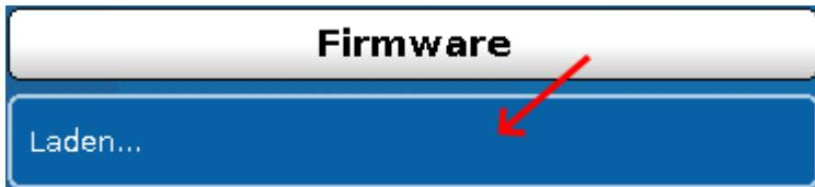
Von der SD-Karte kann die Firmware (= Betriebssystem, Datei **\*.bin**) in den Regler oder auch in andere x2-Geräte (ausgenommen: andere UVR16x2) am CAN-Bus geladen werden. Es können mehrere Betriebssystemversionen auf der SD-Karte gespeichert sein.
