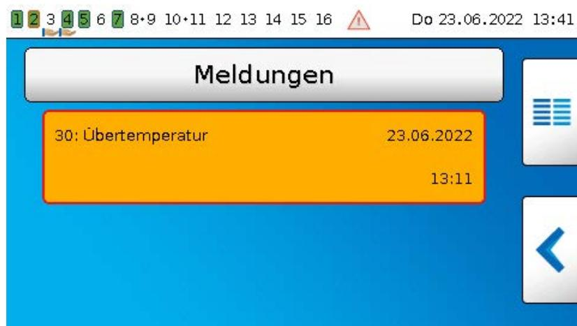
Ist mindestens eine Meldung aktiv, so wird in der oberen Statuszeile ein Warndreieck eingeblendet. Wurde die Meldung verborgen, kann durch Antippen des Dreiecks das Pop-Up-Fenster der Meldung angezeigt werden.
