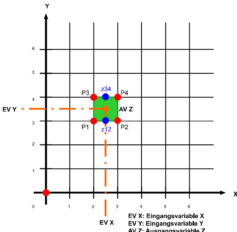
Für die Berechnung des Z-Wertes werden zuerst die 2 Mittelwerte zwischen P1 und P2 ( $z_{12}$ ) bzw. P3 und P4 ( $z_{34}$ ) berechnet. Aus diesen beiden Mittelwerten  $z_{12}$  und  $z_{34}$  wird dann ein weiterer Mittelwert berechnet, der als Ausgangsvariable Z ausgegeben wird.
