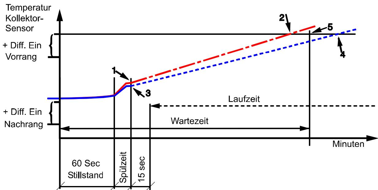
Während der Ladung in den Nachrangverbraucher beobachtet das Gerät die Kollektortemperatur. Erreicht die Kollektortemperatur bei bereits laufender Pumpe wieder die **Einschalt**differenz (Kollektor - Referenz) des **momentan** zugeschalteten Verbrauchers, wird der Vorrangtimer aktiviert. Bei Verwendung eines Strahlungssensors muss die Strahlung an Stelle der Temperaturdifferenz einen Schwellwert überschreiten.
