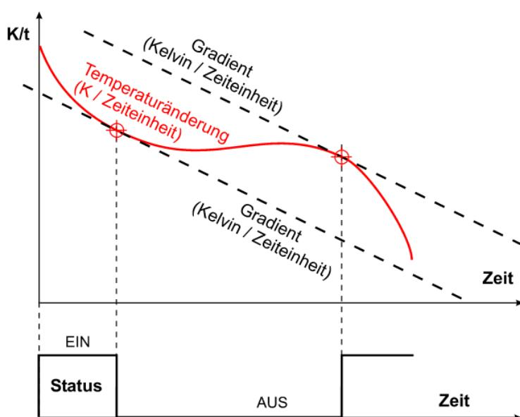
In dem Punkt, in dem die Kurve der Temperaturänderung steiler als der Gradient wird, geht der Status auf EIN.
