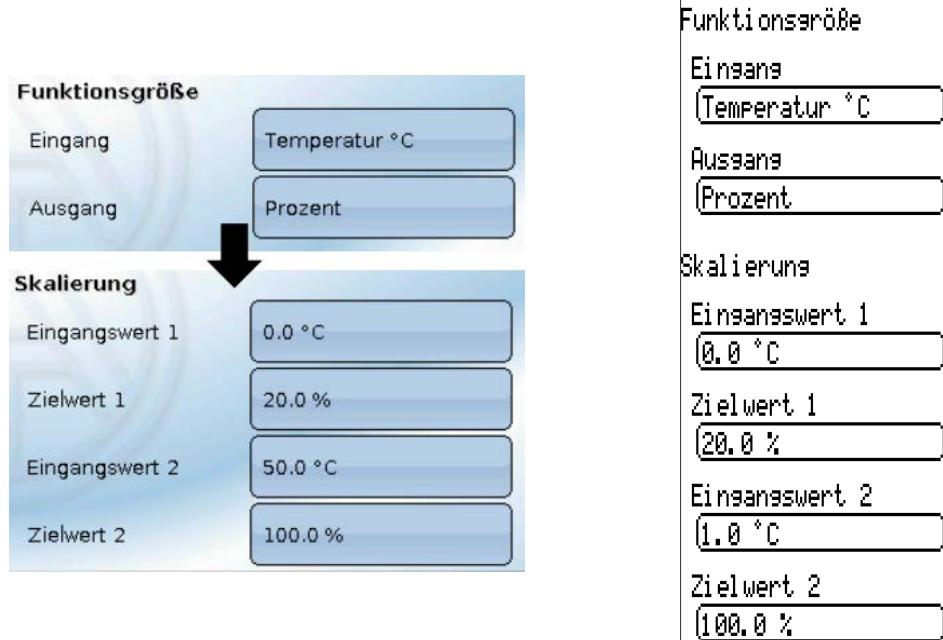
Damit erhält man einen Prozentwert der einer Temperatur entspricht. Ist also z.B. die Eingangsvariable 25,0°C, so wird 60,0% ausgegeben.
