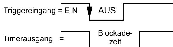
Einstellung „**Retriggern = Ja**“: Wird innerhalb der Blockadezeit der Triggereingang auf EIN gesetzt, beginnt die Blockadezeit neu, wenn der Triggereingang **innerhalb der ursprünglichen Blockadezeit** wieder auf AUS gesetzt wird.
