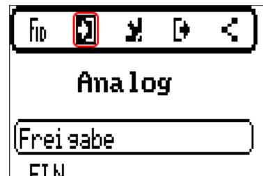
Durch Anwahl des Symbols werden alle Eingangsvariablen der Funktion angezeigt.
