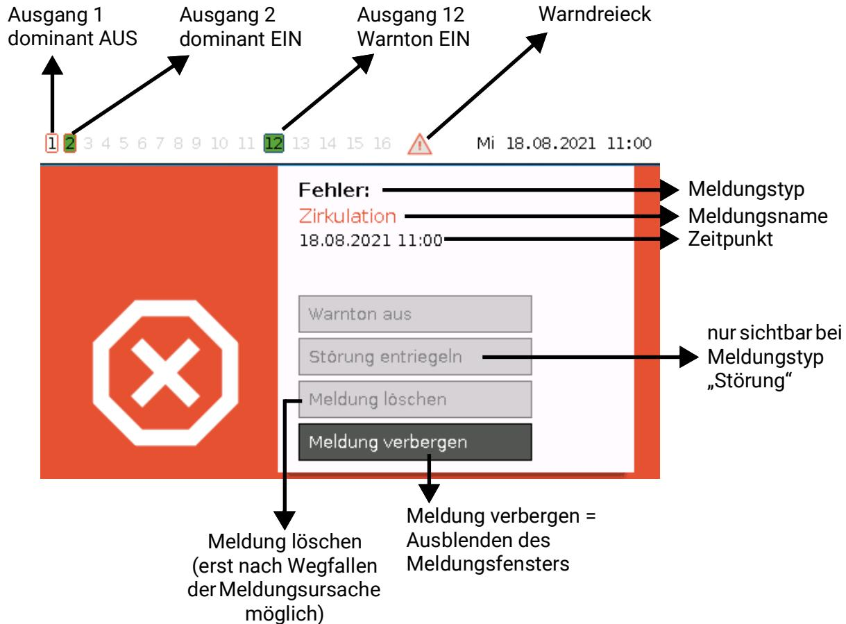
Wurde das Meldungsfenster ausgeblendet, kann es durch Anwählen des **Warndreiecks** in der Statusleiste wieder angezeigt werden.
