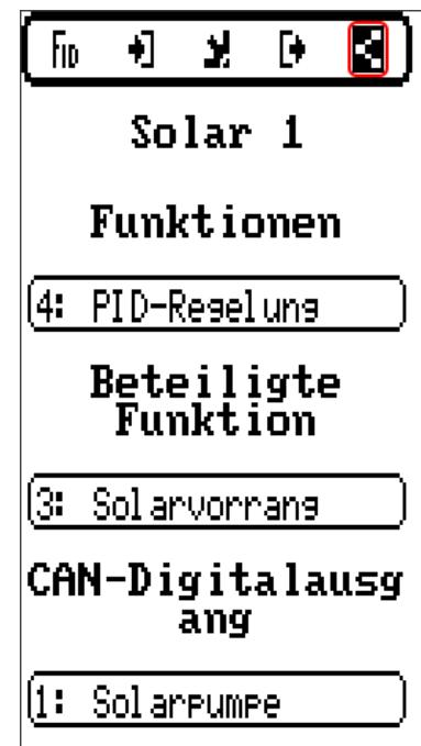
**Funktionen:** Eine Ausgangsvariable von „Solar 1“ ist mit einer Eingangsvariable der Funktion „PID-Regelung“ verknüpft.
