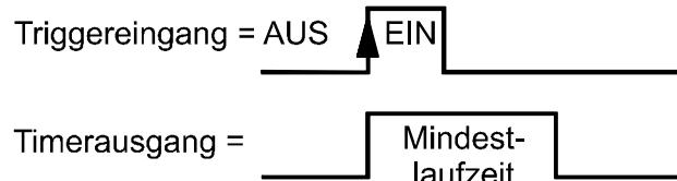
**Blockadezeit:** Das EIN-Signal am Triggereingang schaltet den Ausgang erst wieder ein, nachdem **seit dem Ende** des EIN-Signals die Blockadezeit abgelaufen ist.
