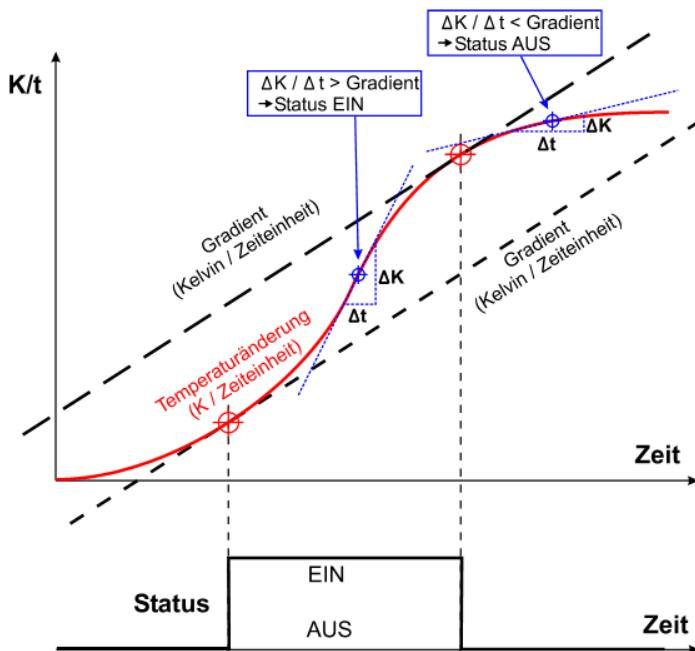
Der Status geht auf EIN, wenn der Temperaturanstieg innerhalb eines Zehntels der eingestellten Zeiteinheit höher als der eingestellte Gradient ist.
