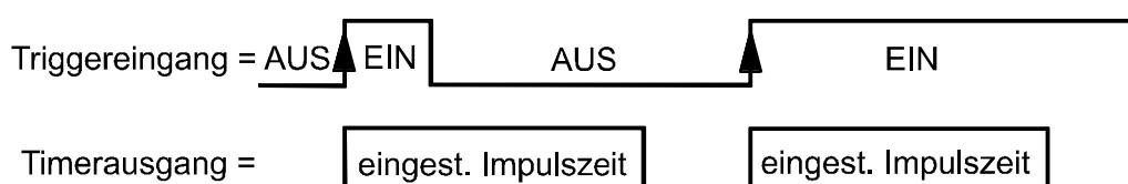
Eine **positive** Triggerflanke ist die Änderungen des Eingangszustandes von „AUS“ nach „EIN“ oder von „Schalter offen“ auf „Schalter geschlossen“ (= schließend). Das entspricht dem obigen Beispiel.
