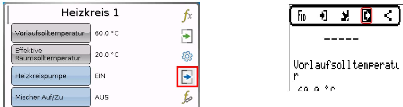
Bestimmte Ausgangsvariablen können **nicht** mit Ausgängen verknüpft werden, diese sind farblich anders gekennzeichnet (UVR16x2 und CAN-MTx2).
