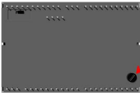
Glasrohrsicherung 20x5 mm, 6,3A flink
