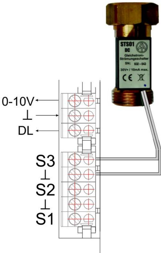
Der Anschluss erfolgt immer an einen Sensor-eingang und die Sensormasse.
