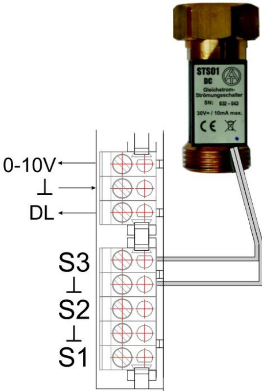
Le raccordement se fait toujours sur une entrée de capteur et sur la masse du capteur. La polarité des raccords est interchangeable et ne doit pas obligatoirement être respectée.
