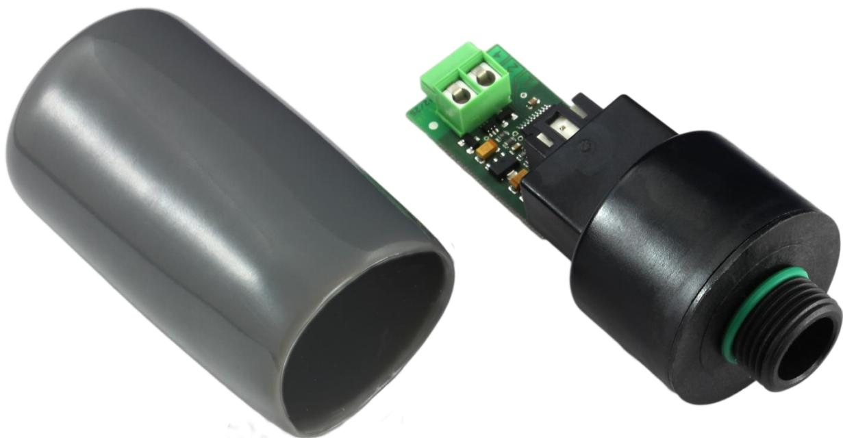
Der Drucksensor PRS0-6DL dient zur Erfassung der physikalischen Größe Druck. Er eignet sich insbesondere zur Bestimmung von Wasserdruckverhältnissen in Heizungs- und Brauchwasserkreisläufen. Die Adapterelektronik wandelt die Messwerte in ein für den DL-Bus (Datenleitung) geeignetes serielles Digitalsignal um.
