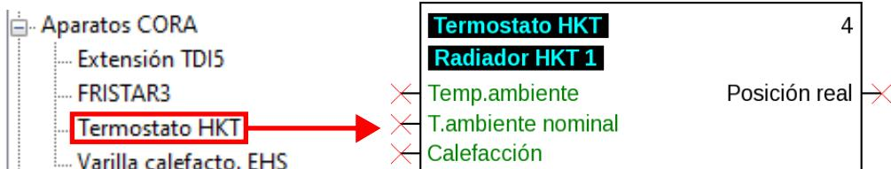
Una aplicación típica sería la conexión con la variable de salida **Temp. amb. efec.** de una función de regulación del circuito de calefacción o un **valor nominal** de una función de temporizador.
