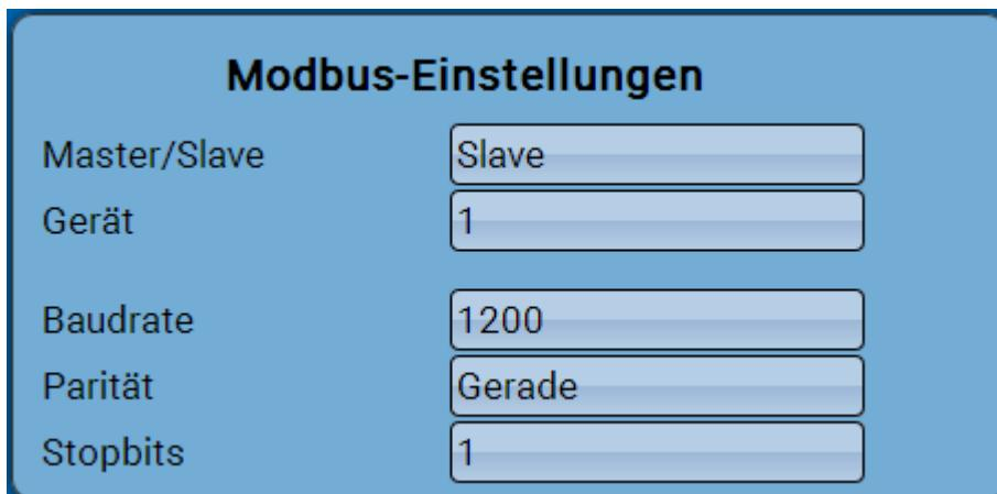
**Gerät:** Im **Slave**-Modus muss zusätzlich die **Gerätenummer** (1 – 247) des Buskonverters im Modbus-Netz festgelegt werden.
