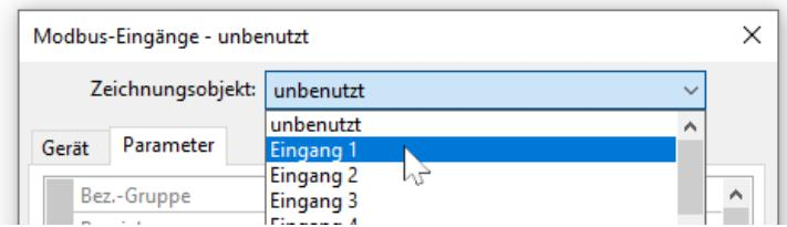
Es können bis zu 64 Modbus-Eingänge programmiert werden. Die Modbus-Eingänge stehen in der Folge den anderen Busausgängen, den Funktions-Eingangsvariablen, der Visualisierung und dem Datenlogging als Quelle zur Verfügung.
