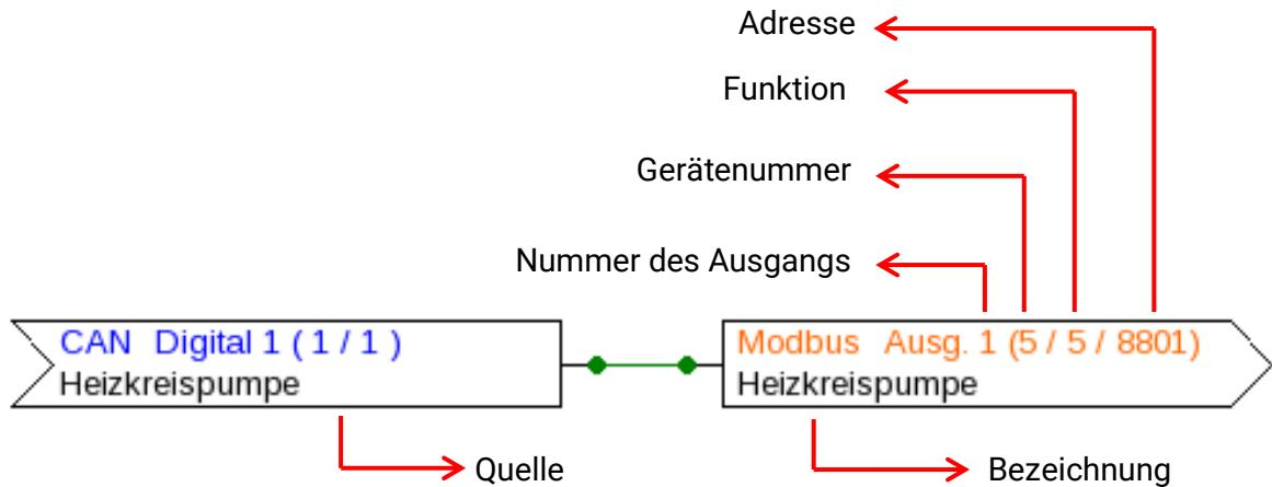
Darstellung eines analogen Modbus-Ausgangs im **Slave**-Modus:
