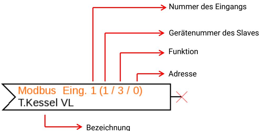
Darstellung eines analogen Modbus-Eingangs im **Slave-Modus**
