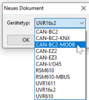
Für die Programmierung eines Buskonverters mit Modbus-Modul muss der richtige Gerätetyp ausgewählt werden.
