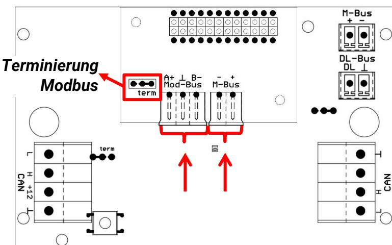
Jedes Modbus-Netzwerk ist beim ersten und letzten Netzwerkteilnehmer mit einem  $120 \Omega$  Busabschluss zu versehen (**mit Steckbrücke terminieren**). In einem Modbus-Netzwerk sind also immer zwei Abschlusswiderstände (jeweils am Ende) zu finden.
