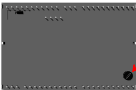
Fusibile in tubo di vetro 20x5 mm, 6.3A rapido
