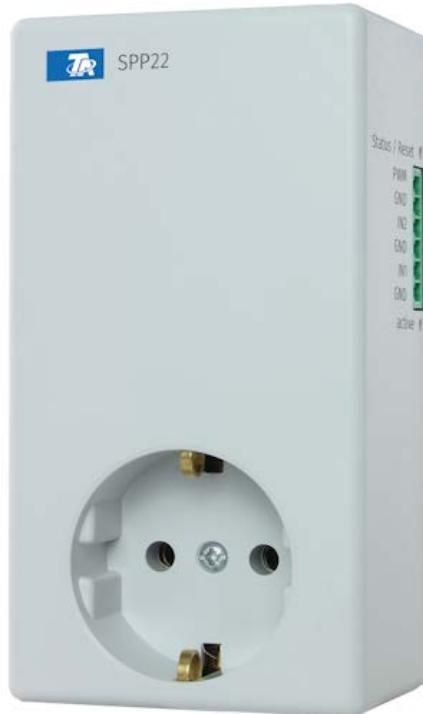
Der SPP22 ist ein Steckdosen-Adapter zum Schalten und Messen des Verbrauchers. Das Gerät muss mit einem Regler per CORA-Funk verbunden werden. Dadurch kann die Stromversorgung des angeschlossenen Verbrauchers geschaltet werden, ebenso werden dessen Leistung und Spannung gemessen.
