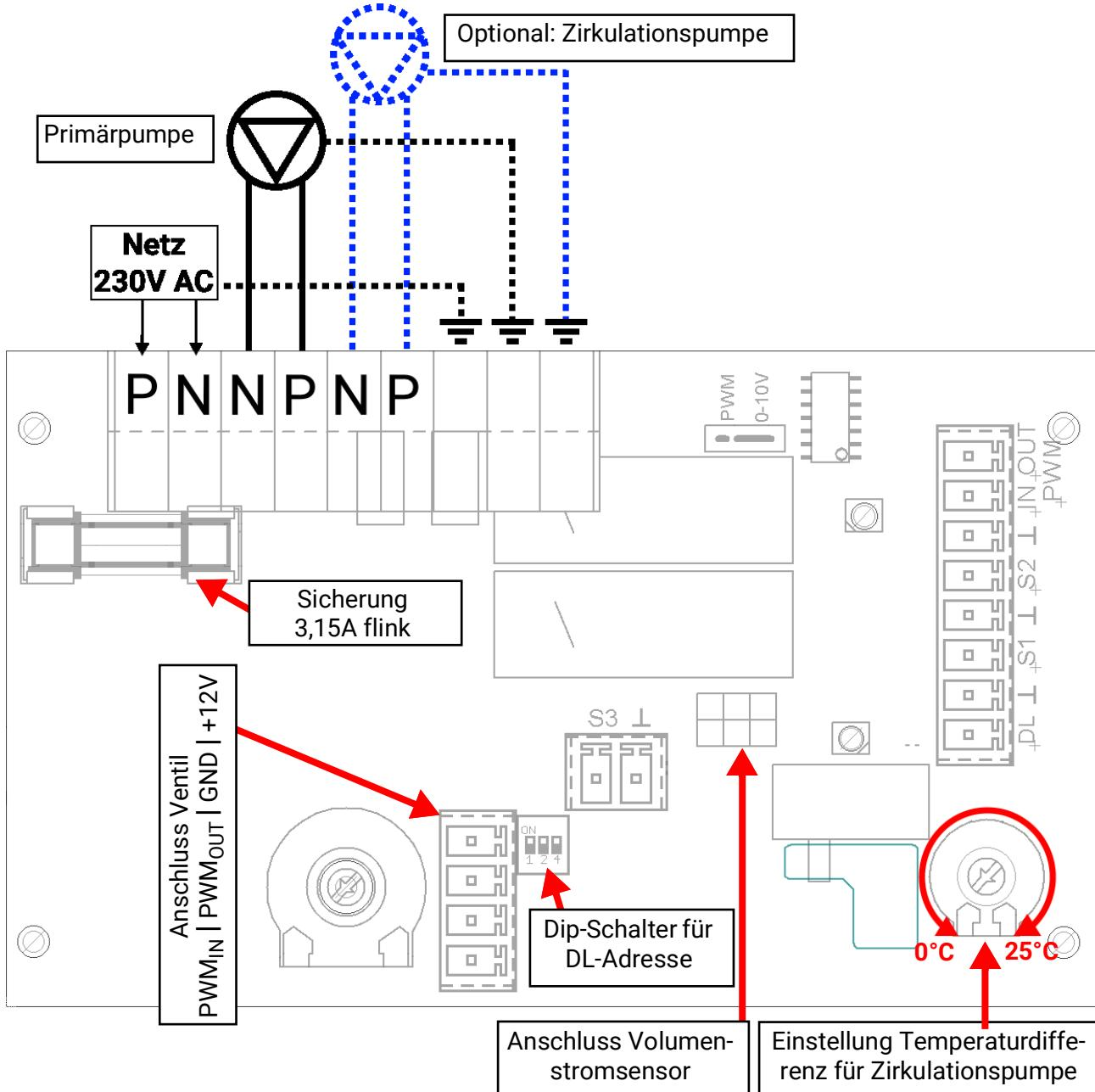
Anschluss S1: Sensor Primärtemperatur  $T_{\text{Pri}}$
