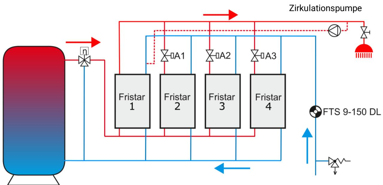
Die Zirkulationspumpe wird nur an die **immer** bereitstehende **FRISTAR3-WP** angeschlossen.
