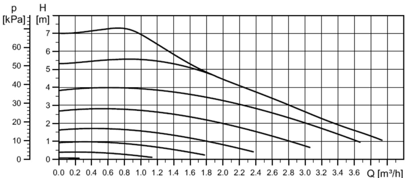
Die Pumpe arbeitet im Heizungsmodus, d.h. die Pumpe hat bei 5% PWM-Wert die volle Drehzahl. Eine Unterbrechung der PWM-Leitung bewirkt daher volle Pumpendrehzahl.
