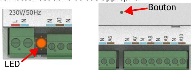
Plus la LED s'allume, moins le servomoteur est approprié. Après un test, le servomoteur doit refroidir pendant au moins 10 minutes avant qu'un autre test soit réalisé sur le même servomoteur.
