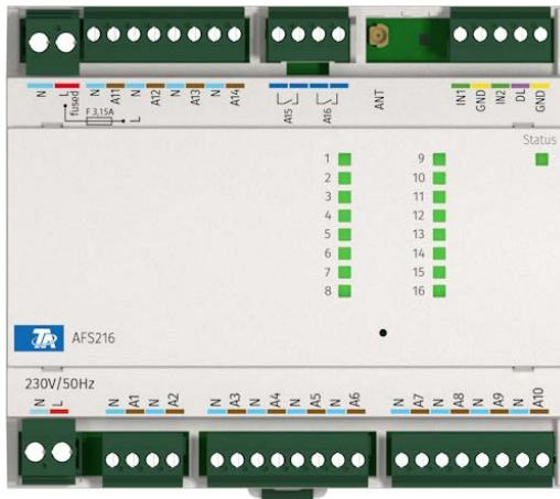
L'actionneur **AFS216** commute jusqu'à 14 servomoteurs thermiques. Ces 14 sorties pour servomoteurs sont conçues pour un courant permanent de 30 mA maximum et des impulsions individuelles (courant d'enclenchement) de 0,5 A maximum. De plus, 2 sorties de relais sans potentiel sont disponibles sous les sorties 15 et 16. Il existe également deux entrées pour capteurs de température PT1000.
