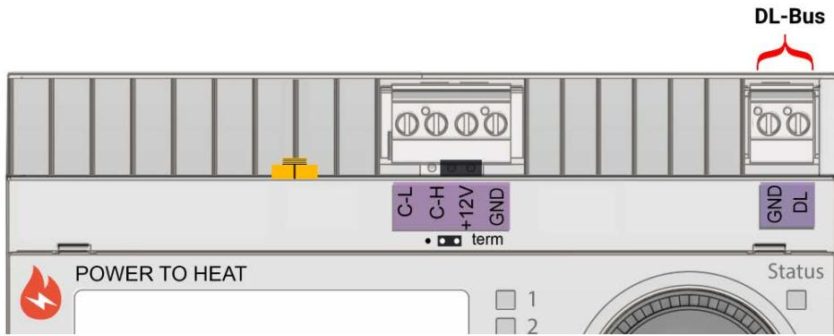
Bei Verwendung einer Kabelverbindung statt Funk muss am CAN-EZ3 unter CORA-Geräte > Heizstab > Parameter die Anbindung auf CORA-DL gestellt werden.
