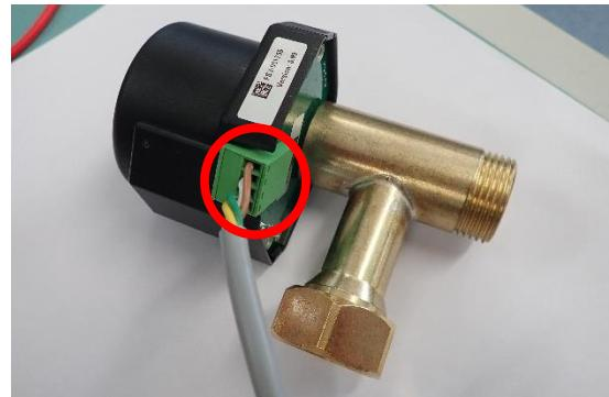
5. Kabel wieder einfädeln und ggf. neuen Kabelbinder setzen. Neues Kabel an gleicher Stelle anstecken. Deckelelektronik wieder befestigen und anschrauben.
