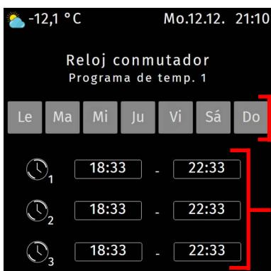
Los 3 primeros intervalos de tiempo de los 2 primeros programas de temporización se pueden ajustar aquí; los demás programas de temporización de la función de **reloj conmutador** puede ajustarse solo en el regulador superior.
