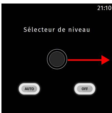
Si le niveau de base est réglé sur 0 et le niveau maximal sur 1, on obtient un interrupteur numérique MARCHE/ARRÊT. Dans ce cas, la page du sélecteur de niveau a un bouton pour l'activer / le désactiver.
