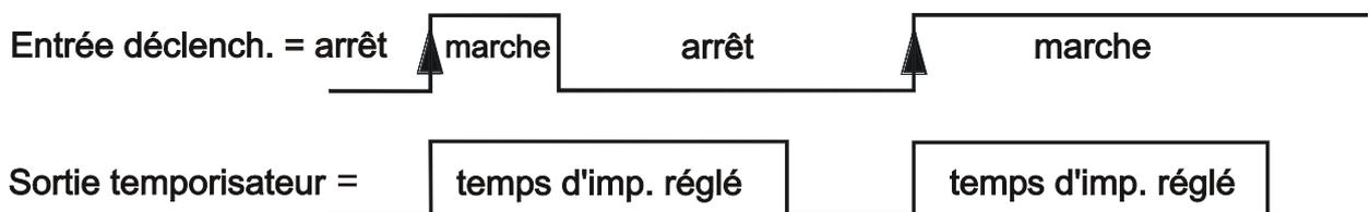
Un flanc de déclencheur positif est une modification de l'état d'entrée de « ARRET » à « MARCHÉ » ou de « Commutateur ouvert » à « Commutateur fermé » (= fermant). Le changement de fermé à ouvert (= ouvrant) est un flanc de déclenchement négatif. Avec FLANC DE DECLENCHEMENT = *pos/neg*, il se produit un démarrage du temporisateur pour chaque changement d'état à l'entrée.
