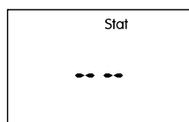
Control de funcionamiento desactivado
