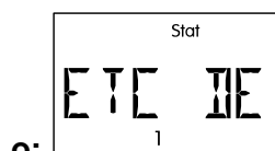
o: Colector – desconexión de exceso de temperatura está activada
