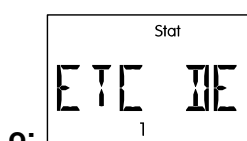
o: Disattivazione per eccesso di temperatura collettore attivo
