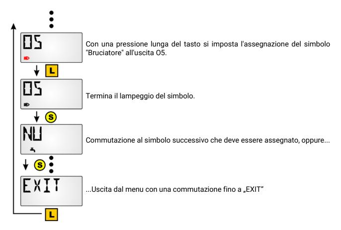
Nel caso in cui il simbolo venga assegnato ad una **Uscita** oppure ad una **Entrata di rete CAN digitale** (UVR1611), viene visualizzato in ogni vista del display fino a quando l'uscita o l'entrata di rete digitale si trova su "ON".
