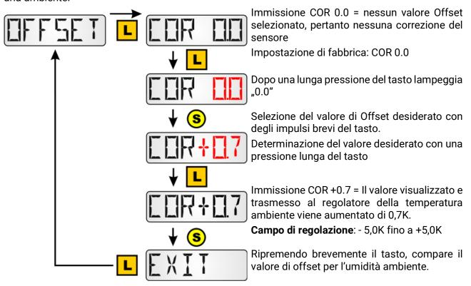
**Esempio**: Nel caso di un valore di Offset di 0,7K ed una temperatura rilevata di 21,0°C vengono visualizzati 21,7°C (Valore indice 1 e 2). Questo valore corretto è utilizzato in seguito per tutti i calcoli e trasmesso ai regolatori.
