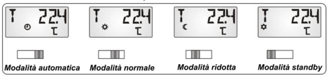
Il segnale trasmesso al regolatore corrisponde alla temperatura ambiente modificata con il pulsante girevole. In base alla posizione del tasto, al regolatore vengono trasmessi i seguenti segnali:
