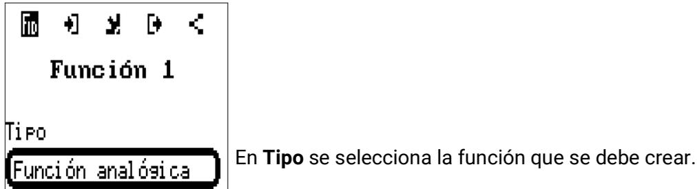
La línea de la parte superior del menú Función proporciona acceso a **fiD** (tipo y designación), **variables de entrada, parámetros, variables de salida y enlaces**.
