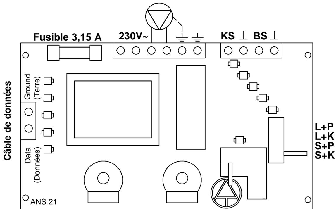
Lors de l'utilisation de la fonction maître - esclave, le câble de données doit être relié **en phase** aux deux appareils (données à données, terre à terre).
