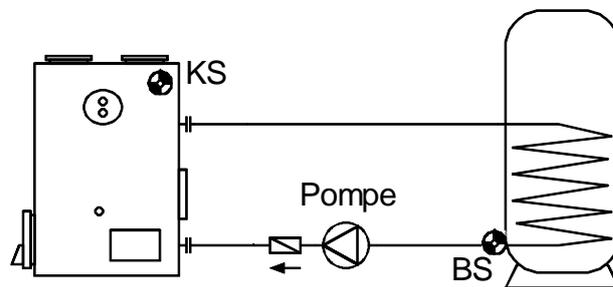
La pompe fonctionne lorsque le capteur **KS** est supérieur au seuil **max** (utilisé ici comme « min ») et le capteur **KS** est supérieur de la différence **diff** au capteur **BS**.
