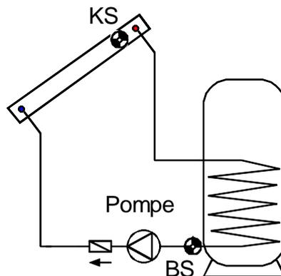
La pompe fonctionne lorsque le capteur **KS** est supérieur de la différence **diff** au capteur **BS** et **BS** n'a pas dépassé le seuil **max**.
