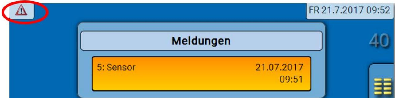
Ist mindestens eine Meldung aktiv, so wird in der oberen Statuszeile ein Warndreieck eingeblendet. Genauere Erläuterungen zu den Meldungen werden in den Programmieranleitungen der frei programmierbaren Regler UVR16x2/UVR610 und RSM610 angeführt.
