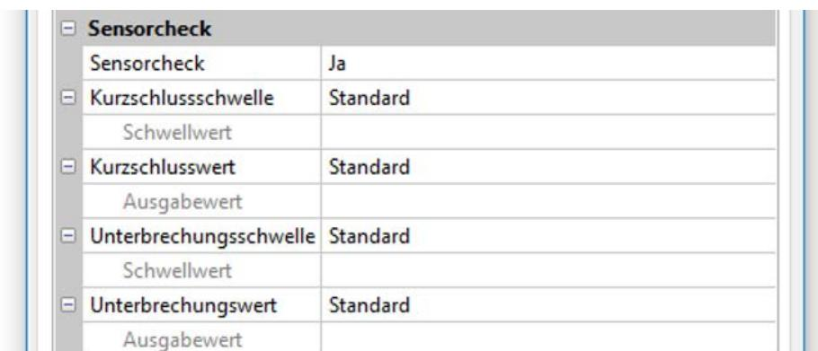
Werden die **Standard**-Schwellen gewählt, dann wird ein Kurzschluss bei Unterschreiten der **Messgrenze** und eine Unterbrechung bei Überschreiten der **Messgrenze** angezeigt.
