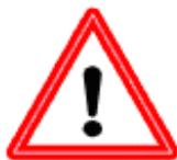
**Tutti gli interventi di montaggio e cablaggio sul regolatore possono essere eseguiti solo in assenza di tensione.**
