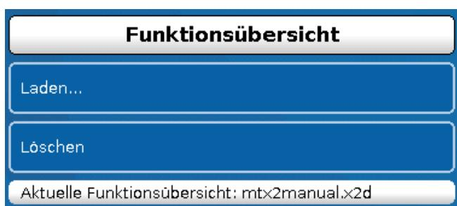
Von der SD-Card kann die Funktionsübersicht (Datei \*.x2d, **TA-Designer Mindestversion: 1.15**) in das Gerät geladen oder im Gerät gelöscht werden. Es können mehrere Dateien auf der SD-Karte gespeichert sein.
