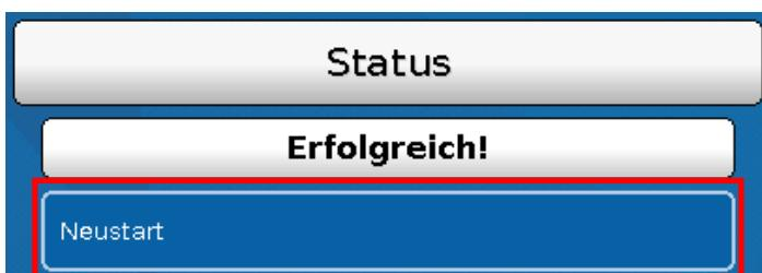
Am Ende des Menüs „Datenverwaltung“ besteht die Möglichkeit, einen Neustart des **Monitors** nach einer Sicherheitsabfrage durchzuführen ohne den **Monitor** vom Netz zu trennen.
