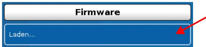
Von der SD-Card kann die Firmware (= Betriebssystem, Datei \*.bin) in den CAN-Monitor oder auch in andere x2-Geräte am CAN-Bus geladen werden (**Ausnahme: UVR16x2**). Es können mehrere Betriebssystemversionen auf der SD-Karte gespeichert sein.
