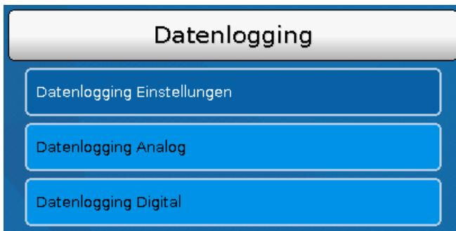
In diesem Menü werden die Parameter für das CAN-Datenlogging analoger und digitaler Werte definiert.
