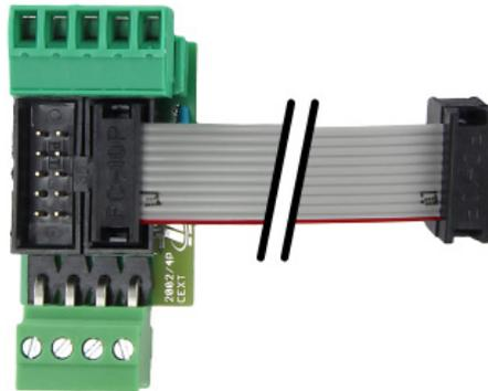
Mit dem **CAN-Bus Verbinder** CBV können zwei Geräte wie der Regler UVR610 oder der Energiezähler CAN-EZ3, die in einem Schaltschrank nebeneinander eingebaut sind, einfach per CAN-Bus verbunden werden.
