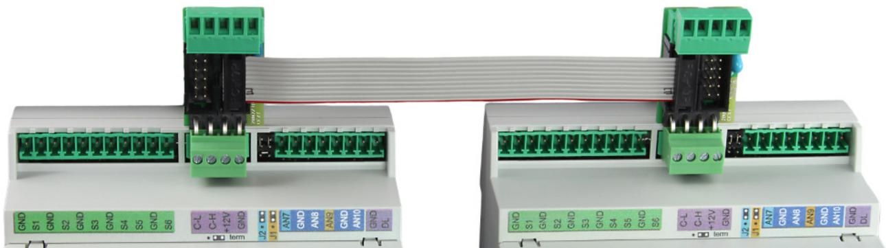
Das Flachbandkabel entspricht nicht vollständig den Spezifikationen des CAN-Bus Protokolls, was bei dessen kurzer Länge (123 mm) jedoch irrelevant ist.
