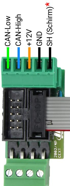
\*Der 5te Pol (rechts an der Klemme) ist für den Schirm der CAN-Busleitung.
