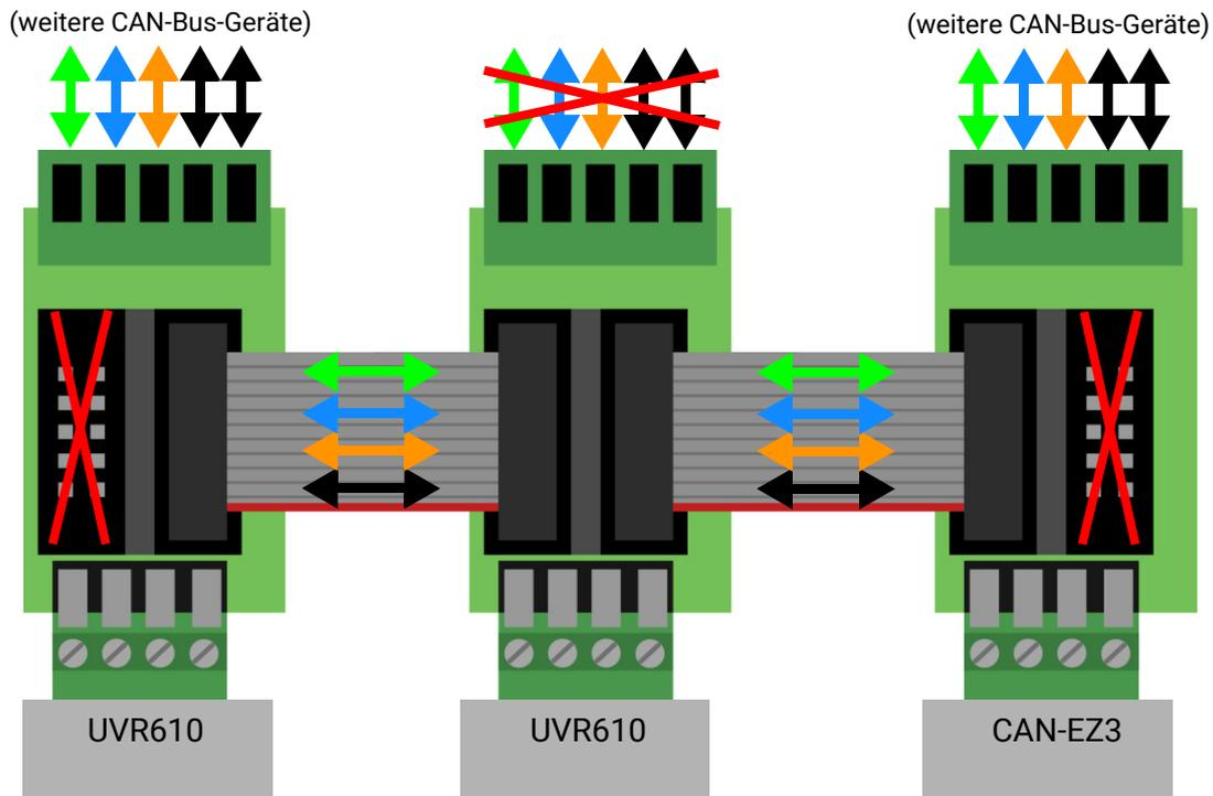
An einem per CBV verbundenem CAN-Bus-Gerät kann die Strangleitung natürlich auch enden. Es ist wie gewöhnlich am Gerät selbst die Terminierung zu setzen.
