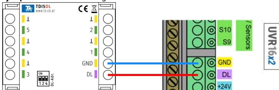
Los fundamentos del cableado del bus DL se explican exhaustivamente en las instrucciones de montaje de los reguladores de programación libre. La polaridad de la línea de datos es intercambiable.
