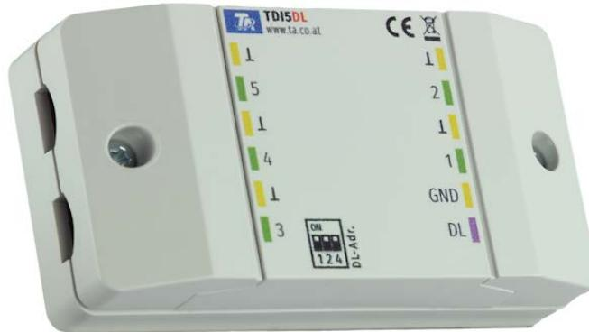
**TDI5-DL** (Temperature and Digital Input) traduce hasta cinco señales para la línea de datos (Bus DL), que pueden ser una señal digital (On/Off) o un valor de medición de un sensor PT1000. **Las señales digitales deben ser de cero voltaje.** **Atención:** debido a la capacidad de carga del bus DL, este módulo **no** es adecuado para aplicaciones en las que el tiempo es un factor crítico (p. ej., entradas digitales como palpador).
