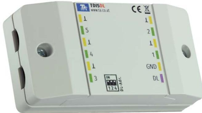
**TDI5-DL** (Temperature and Digital Input) convertit jusqu'à cinq signaux pour le câble de données (bus DL); il peut s'agir de signaux numériques (Marche/Arrêt) ou de valeurs de mesure d'un capteur PT1000. **Les signaux numériques doivent être libres de potentiel.**
