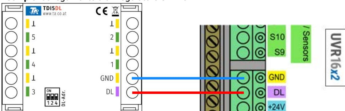
Le basi del cablaggio del bus DL sono descritte in dettaglio nelle istruzioni di montaggio dei tre regolatori programmabili. L'assegnazione dei poli della linea dati è intercambiabile.
