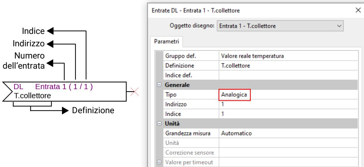
Le impostazioni principali si trovano alla voce **Generale**. Se si dovesse rilevare un'entrata digitale (ON/OFF) (Index 1-5), il tipo deve essere impostato su **Digitale**, invece di **Analogico**. Inoltre si devono indicare l'indirizzo bus DL impostato sull'TDI5-DL (impostazione di fabbrica 1) e l'indice dell'entrata desiderata.
