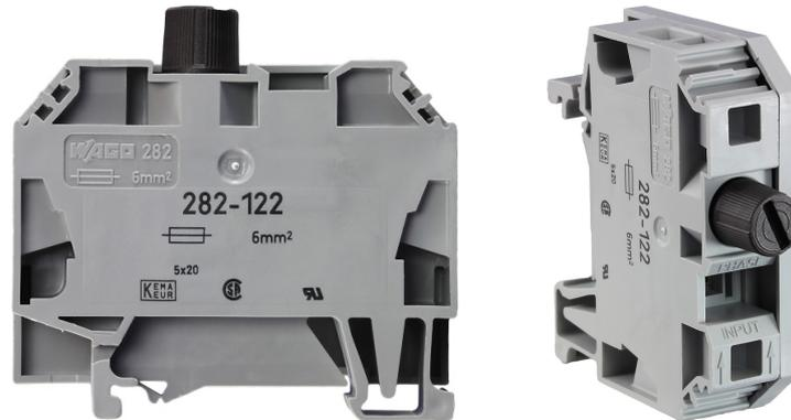
La base portafusible SKL5x20 (con fusible rápido 6,3 A) sirve para protección externa del regulador UVR610. El fusible interior del UVR610 solo se puede cambiar en las instalaciones del fabricante. Al conectar la base portafusible a **L1**, se puentea el fusible interno del aparato. El fusible que se encuentra dentro de la base portafusible se puede cambiar *in situ* fácilmente.
