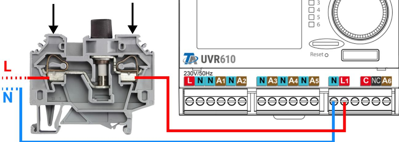
La base portafusible debe conectarse a **L1**. Debe tenerse en cuenta la dirección indicada por el gráfico de conexión (véase la inscripción «INPUT» de la parte superior).
