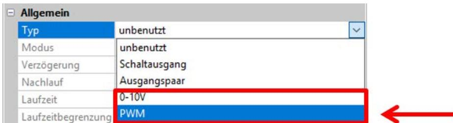
Die **Ausgänge 4 und 5** stellen eine Spannung von 0 bis 10V zur Verfügung, z.B. zur Leistungsregelung von Brennern (Brennermodulation) oder Drehzahlregelung von Elektronikpumpen.
