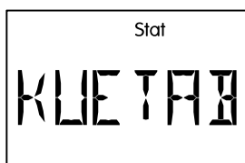
Kollektor túlhevülés lekapcsolás aktív
