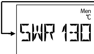
Požadovaná hodnota regulace
