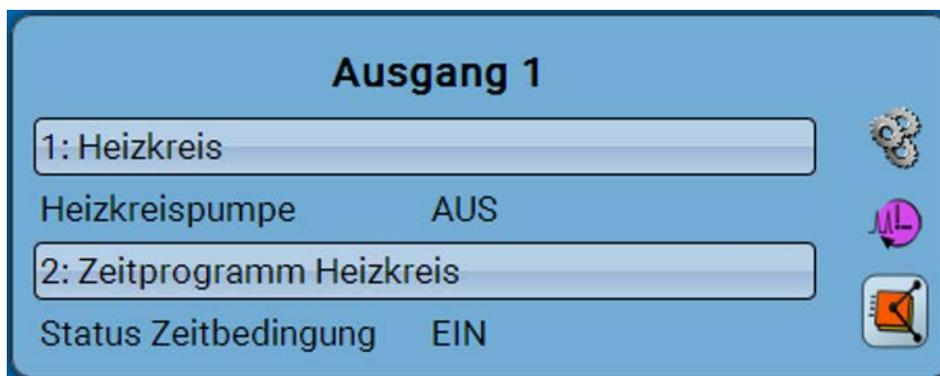
In diesem Beispiel wird der Ausgang 1 von 2 Funktionen angesteuert, wobei er gerade von der Funktion 2 (Schaltuhr) eingeschaltet wird.
