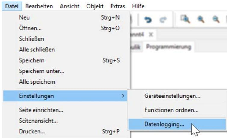
In diesem Menü werden die Parameter für das CAN-Datenlogging analoger und digitaler Werte definiert.
